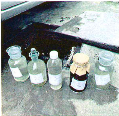
图 1 污水处理设施处理前水样
